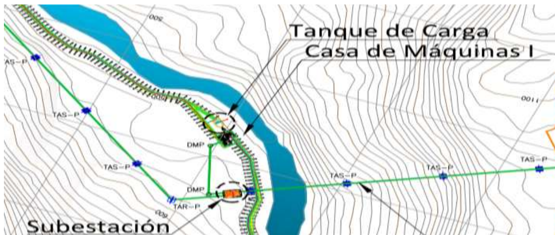
Figura 6. Ubicación del Tanque de carga con relación al Río Zempoala, la subestación y la casa de Máquinas I
