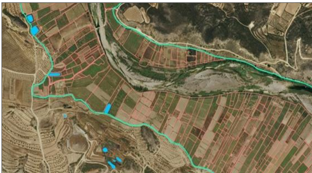
Imagen 24. Muestra de la cartografía realizada en la que se tienen georreferenciadas las balsas y los canales y acequias de riego
