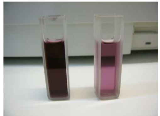
Figura 13. Reacción de decoloración, por neutralización del radical DPPH.
