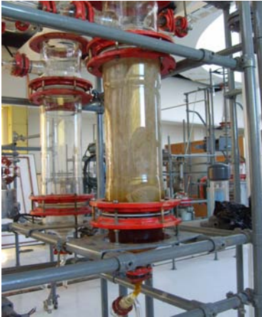
Figura 6. Sistema de Extracción por maceración.
