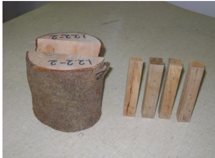
Figura 4. Rodela y probetas obtenidas del árbol inclinado
