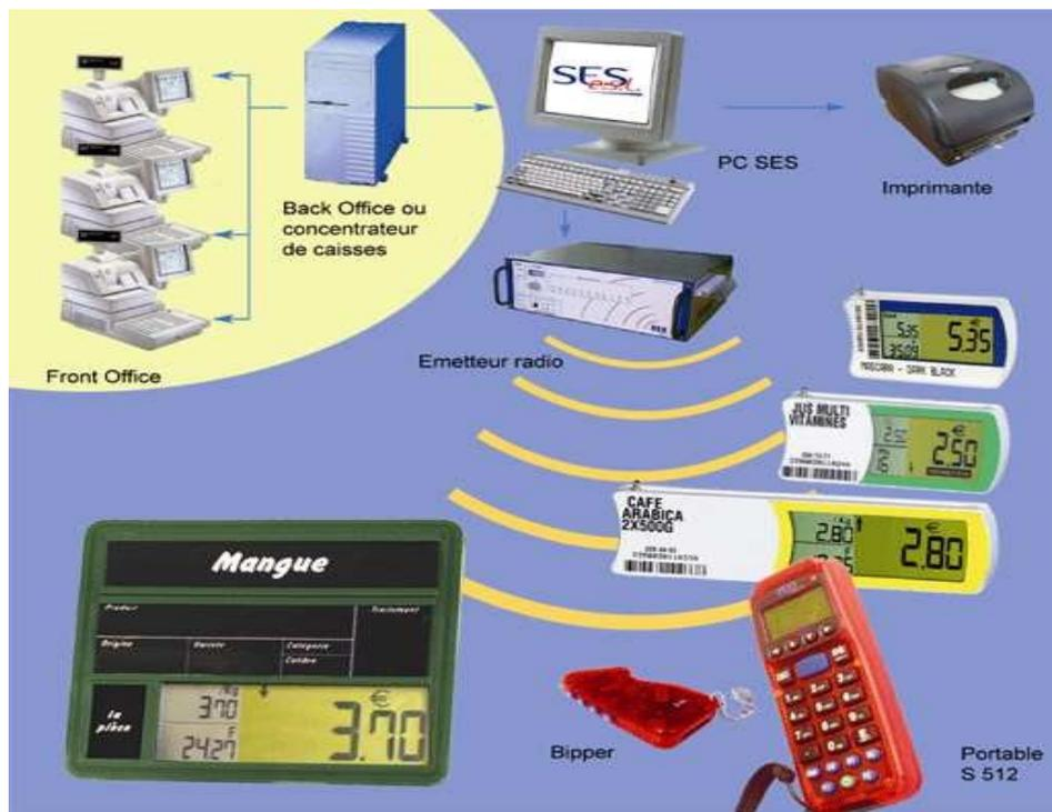
La mise à jour d'une étiquette est quasi-immédiate puisqu'elle peut être effectuée en 3 secondes, dès lors que l'ordinateur constate une différence ou une modification du prix sur le serveur, il envoie automatiquement la nouvelle information à l'émetteur qui la répercute sur les étiquettes correspondantes.
