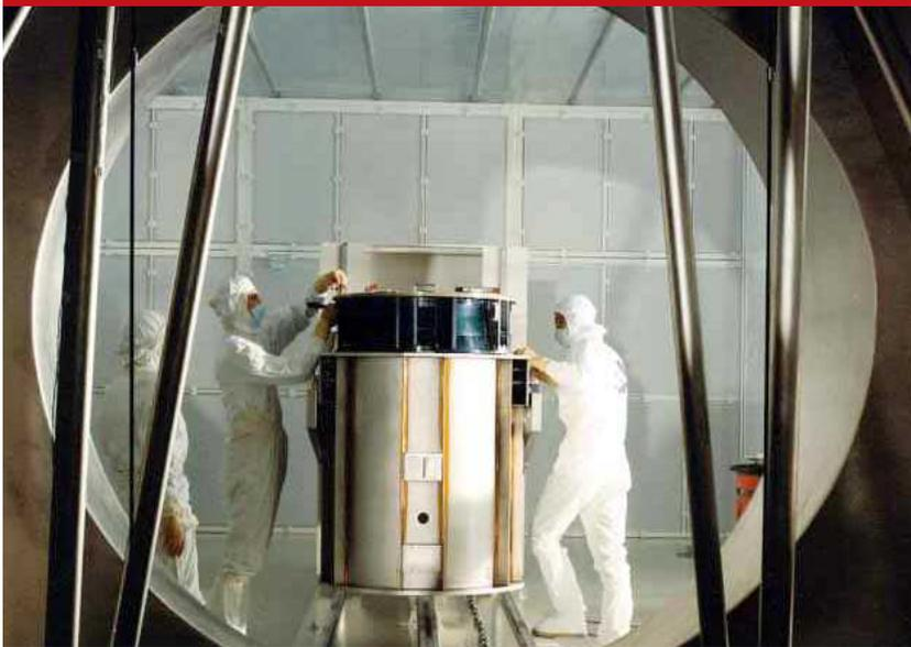
Montage des Röntgenteleskops XMM
