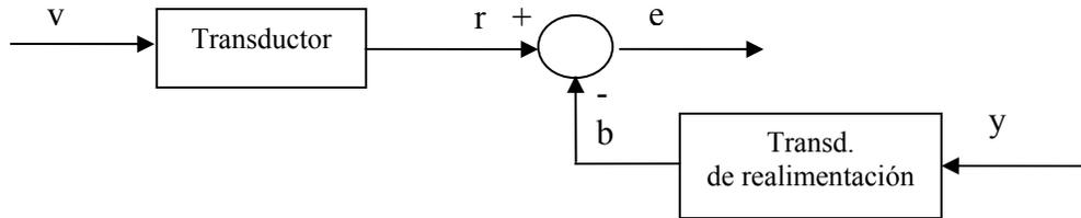
Figura 29. Transductor en la señal de entrada.
