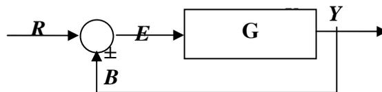
Figura 32. Sistema de control con realimentación unitaria.
