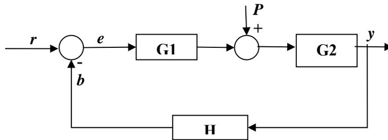
Figura 13. Sistema Realimentado con Señal de Perturbación.
