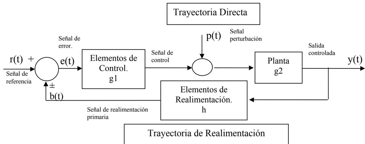
Figura 28. Diagrama en Bloques de Sistema de Control Realimentado.
