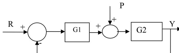
Figura 34- Sistema de control con dos entradas.
