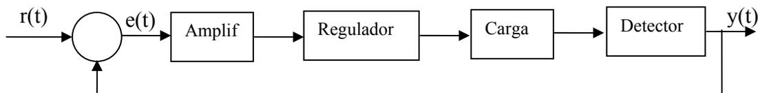
Figura 21. Diagrama en Bloques de un Sistema Típico.
