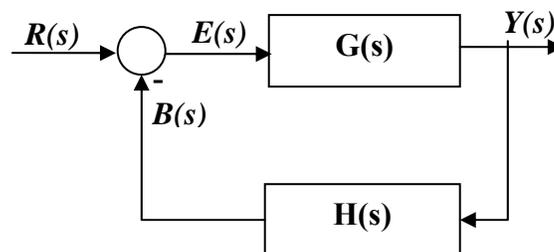
Figura 30. Sistema de control realimentado.
