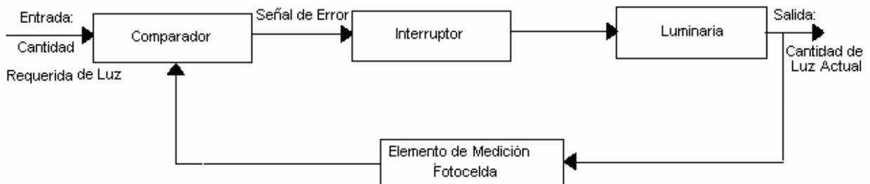
Figura 9. Diagrama en Bloques de Alumbrado Público
