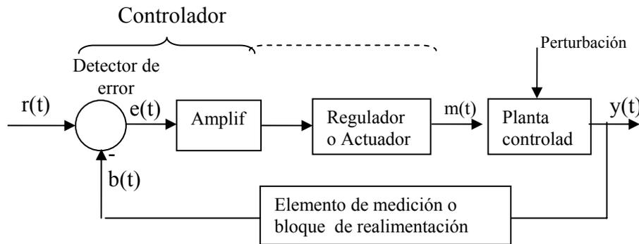
Figura 18. Diagrama de Bloques de un Sistema de Control Automático Continuo.
