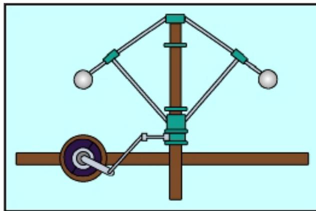
Figura 2. Regulador Centrífugo.
