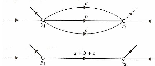
Figura 42. Grafica de Flujo señal con trayectorias paralelas, reemplazadas por una rama sencilla.
