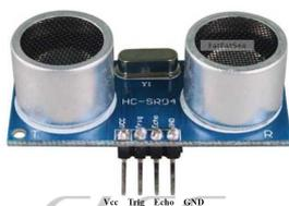
Figura 3.1. Vista del Módulo HC-SRQ4
