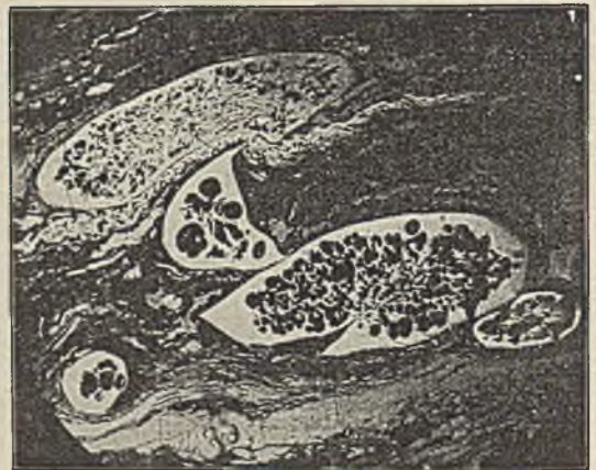
Abb. 3. Mehrere Sklerotien, zum Teil verdrückt, aus demselben Flöz. Senkrechter Schliff. v=160 .
