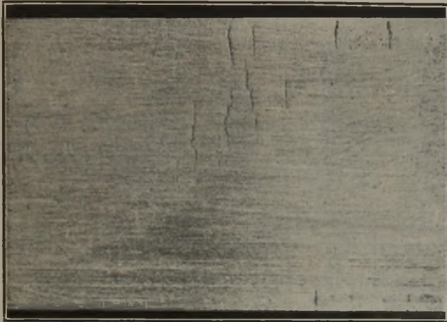
Bild 5. Oberfläche einer schwach rissigen Stahlprobe. (rd. \times 2,5 .)
