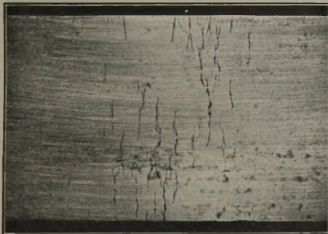
Bild 6. Oberfläche einer stark rissigen Stahlprobe. (rd. \times 2,5 .)
