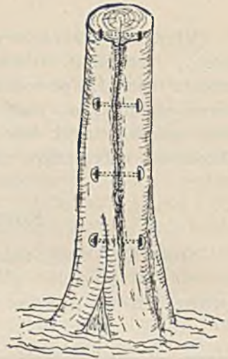
Ryc. 115. Sposób założenia śrub wzmacniających pień z listwą mrozową.
