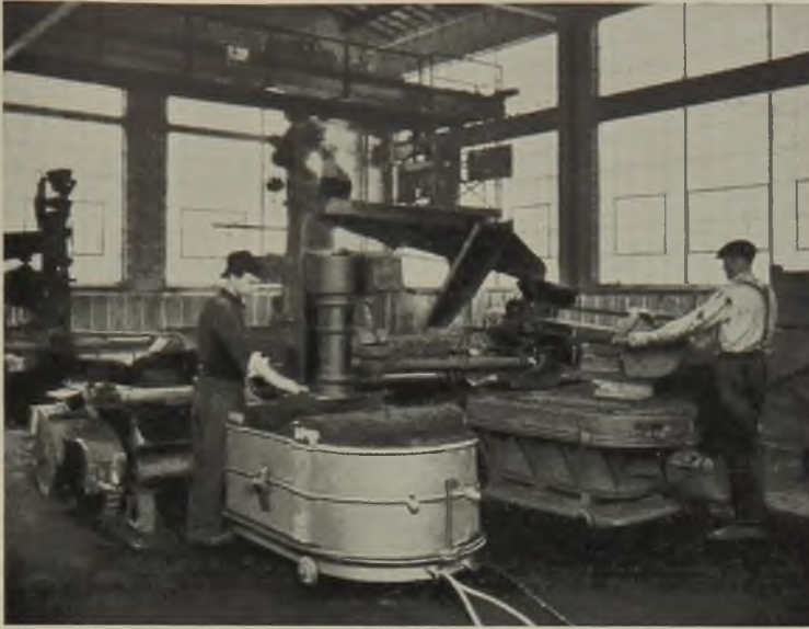
Abb. 1447. Schleudermaschine mit zwei anhängenden Aushebemaschinen für Badewannenmodelle.
