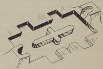
Abb. 139. Frei angefertigte Herdgußform.
