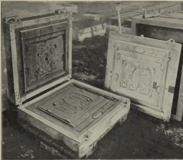
Abb. 1059. Aufgeklappter Formkasten mit ausgehobener Formplatte.
