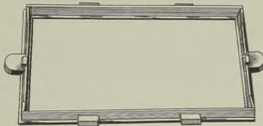
Abb. 1090. Gußeisenrahmen zur Herstellung einer Eisenabgußplatte.
