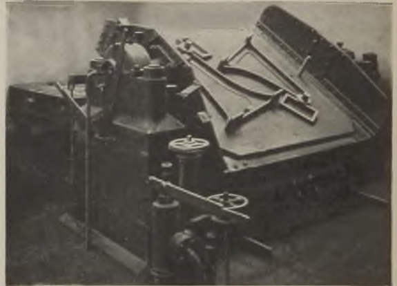
Abb. 1325. Mit Modellen besetzte Wendeformplatte.
