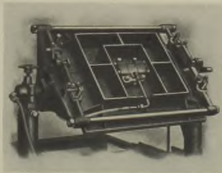
Abb. 1361. Modellplatte mit eingebautem Preßluft-Vibrator.
