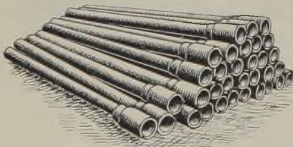
Abb. 570. Kernspindeln für Abflußröhren.
