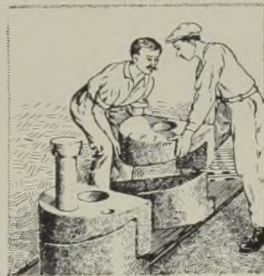
Abb. 1017. Ausschließlich aus Kernen bestehende Form für Manganstahl-Förderwerksflügel.
