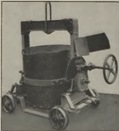
Abb. 1613. Fahrpfanne mit Schneckengetriebe.
