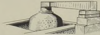
Abb. 998. Gießfertige, eingestampfte Glockenform.
