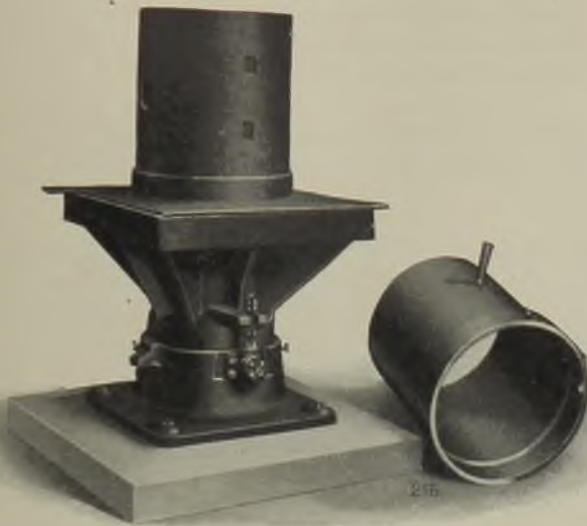
Abb. 1353. Kleinrüttler mit Preßluftantrieb für Kernanfertigung.
