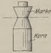
Abb. 95. Prüfung der Konizität des Kerns.
