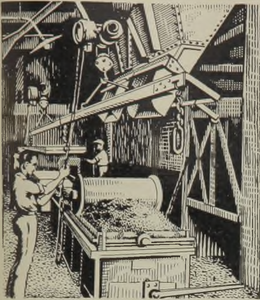
Abb. 1454. Walzformmaschine mit Sandbunker und Sandzuteiler.
