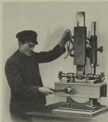
Abb. 1460. Abheben des Kernkastens mit Maschine.
