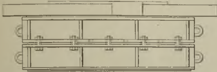
Abb. 961. Gußbereite, fertig verschraubte und beschwerte Form.
