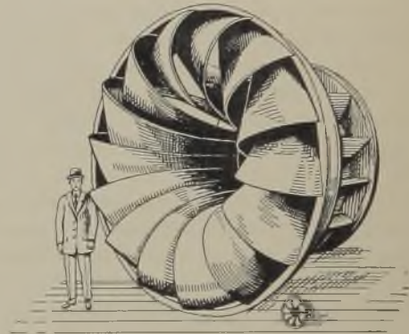
Abb. 778. Turbinenlaufrad mit schmiedeisernen Schaufeln.
