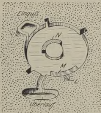
Abb. 137. Herdgußform, durch Lehrenformerei erstellt.
