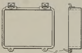
Abb. 1066—1068. Formkastensatz mit Gelenkplatte.
