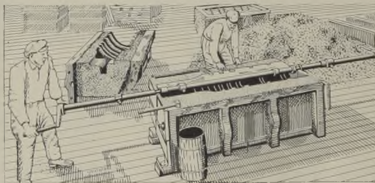
Abb. 523. Ausdrehen des oberen Walzenbundes mit wagerecht gelagerter Lehre.
