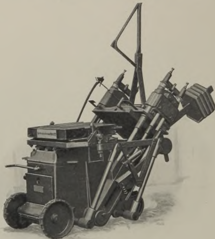
Abb. 1226. Voßmaschine mit Wendevorrichtung.
