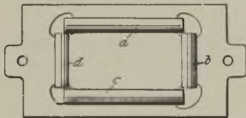
Abb. 1113. Kernplatte mit eingelegten Paßstäben.
