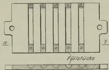
Abb. 1110. Kernplatte mit eingeschraubten Füllstücken.
