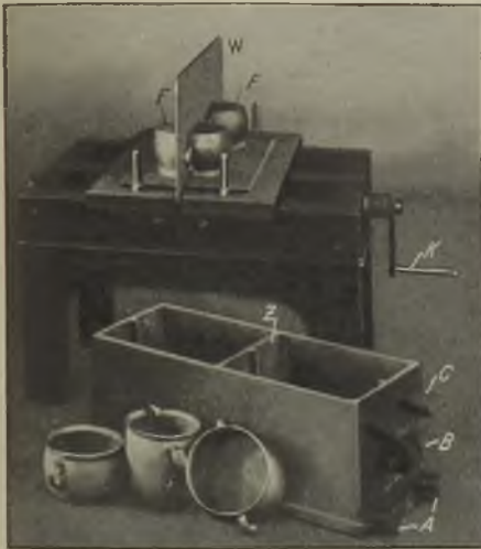
Abb. 1128. Maschine zur Herstellung von Bauchtöpf-Mantelteilen.
