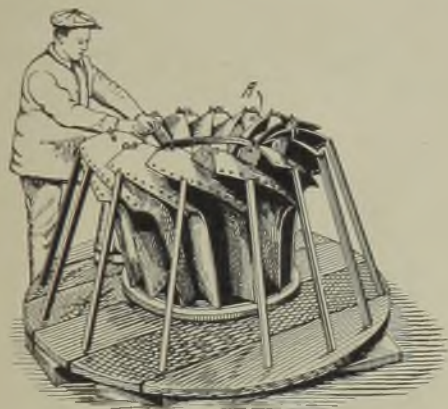
Abb. 779. Einrichtung zum Zusammenstellen der Blechschaufeln.
