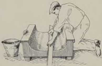
Abb. 807. Glattstreichen der Formmasse in einer Kastenhälfte.
