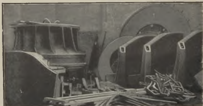
Abb. 772. Links ein der Form entnommener Turbinenläufer, rechts drei Schaufelkerne.
