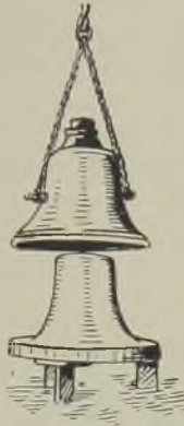
Abb. 997. Zusammensetzen einer Glockenform.
