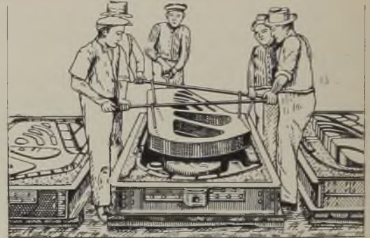
Abb. 582. Einlegen des Kerns in die Gliederkesselform.
