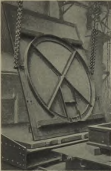
Abb. 1322. Modellplatte aus Holz mit schwachwandigem Modell.
