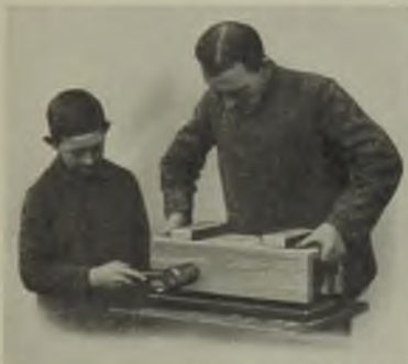
Abb. 1459. Abheben des Kernkastens von Hand.
