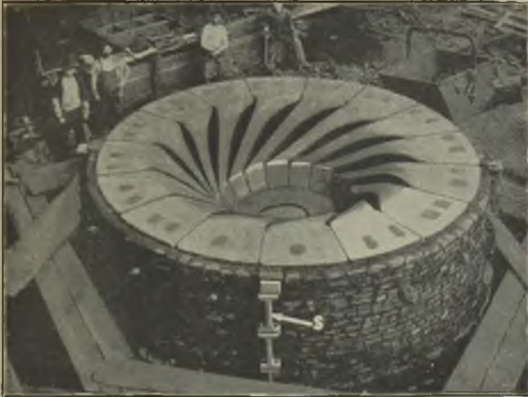
Abb. 770. Turbinenläufer-Form nach der Umwandlung mit einem Ziegelring.
