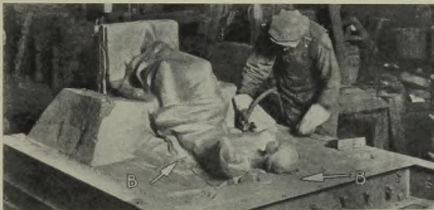
Abb. 715. Ausblasen der getrockneten Form.
