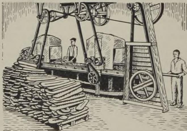
Abb. 592. Aufstapeln der Rippenheizkörper am Putztisch.
