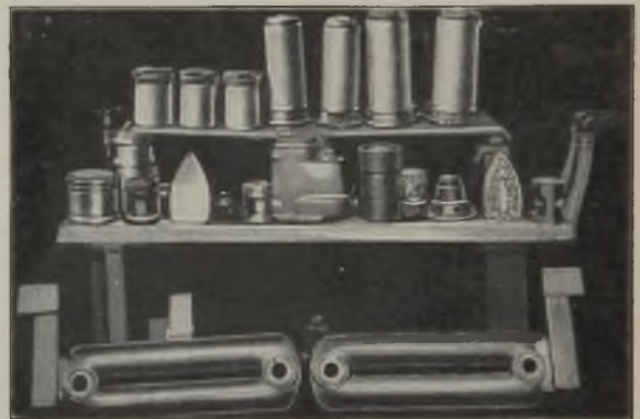
Abb. 1669. Regelmäßig in Dauerformen hergestellte Gußstücke.
