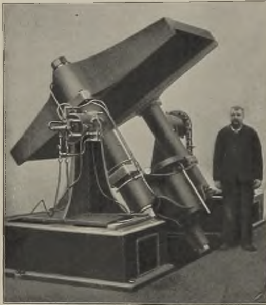
Abb. 1297. Große Druckwasser-Wendeformmaschine mit doppelter Drehachse.
