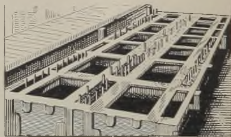
Abb. 743. Putzbereites Wangenteilstück einer Kanonendrehbankwange.
