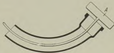
Abb. 121. Kerneisen für Rohrkrümmer.
