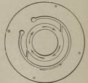
Abb. 603. Eingüß mit zwei tangentialen Anschnitten.
