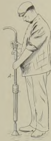
Abb. 10. Preßluftstampfer mit Verlängerungsanschluß.
