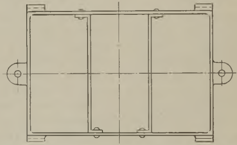
Abb. 40. Formkasten mit angeschraubten Schoren.
