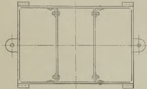
Abb. 31. Formkasten mit seitlichen Ösen.
