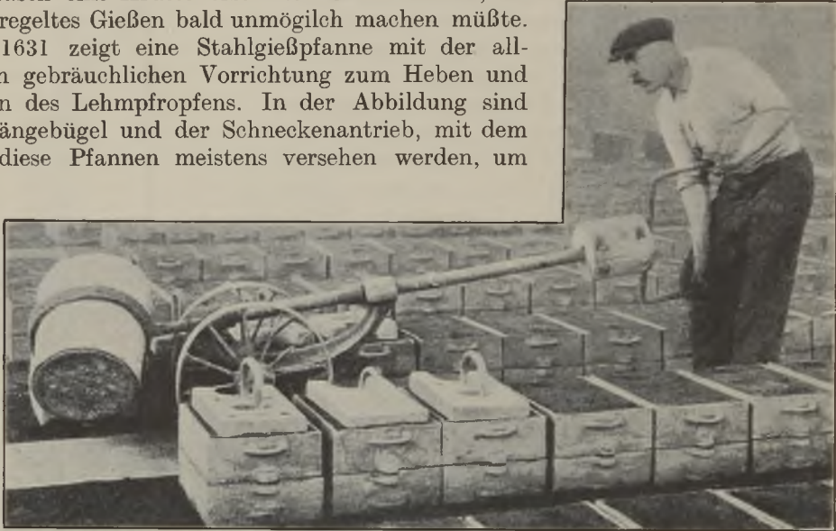
Abb. 1630. Fahrbare Gießpfanne mit Ausgleichgewicht am Drehgabelarm.
