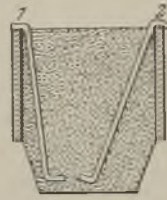
Abb. 176. Falsch und richtig angeordnete Sandhaken.
