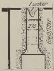
Abb. 526. Lunkerbildung oberhalb des Gießfilters.
