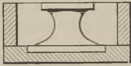
Abb. 148. Modell und Büchse für Zapfenherstellung.
