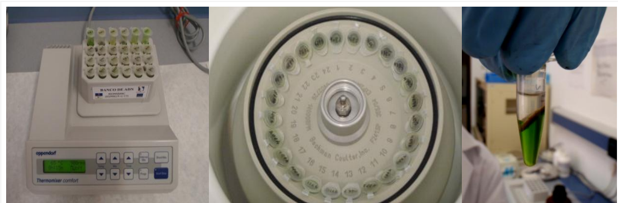
Figura 3.11. Las muestras son sometidas a distintos pasos de agitación, centrifugación y adición de soluciones hasta la formación de varias fases dentro del tubo, quedando en la fase superior translúcida, el ADN. El color verde de la fase inferior es debido a los pigmentos fotosintéticos como la clorofila. (Fotos: Ruth Jaén Molina y Beatriz Rumeu)
