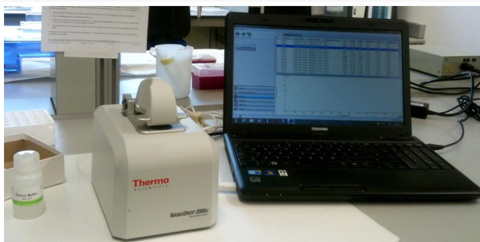
Figura 3.15. Biofotómetro NanoDrop 2000c y ordenador portátil conectado a él para la toma de datos. (Foto: Ruth Jaén-Molina)
