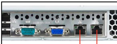
LAN port 1 LAN port 2
