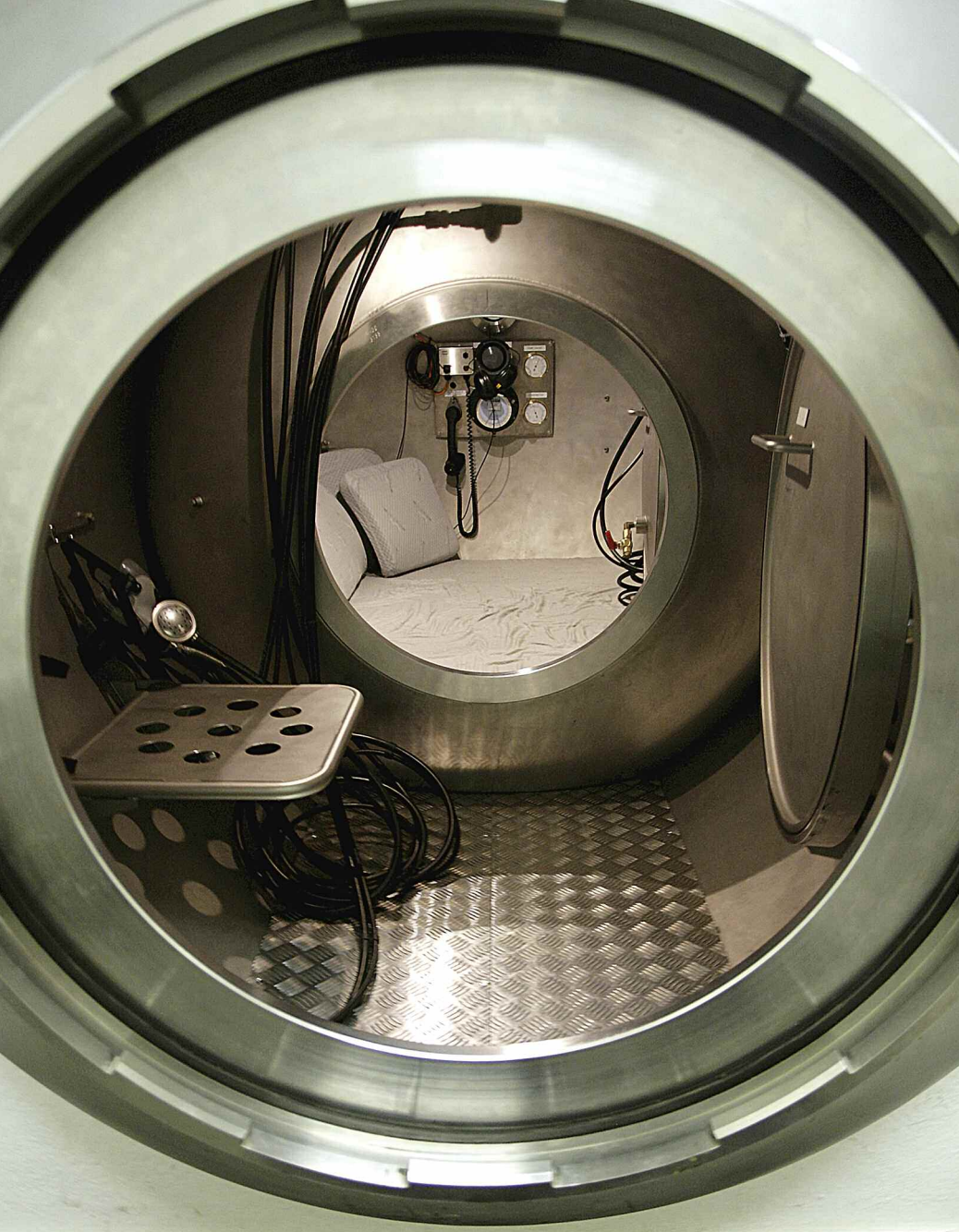
Vadības panelis ļauj precīzi mainīt gaisa spiedienu barokameras iekšienē, imitējot cilvēka atrašanos dažādā dziļumā.
