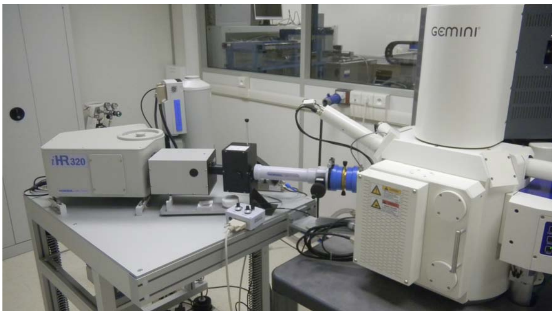
FIGURE 2.8 – Microscope électronique à balayage ZEISS Supra-TM 55 VP avec colonne GEMINI couplé au détecteur de cathodoluminescence.
