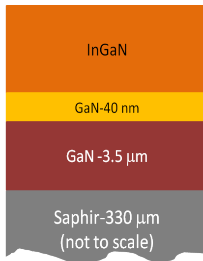
FIGURE 3.2 – Représentation schématique de la structure des échantillons d'InGaN élaborés sur pseudo-substrat de GaN.
