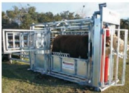
Posee además, un sistema de ajuste bilateral que aprieta el animal por los dos costados, impidiendo su movimiento, mediante un sistema de palancas dentadas. Por otro lado, como el cepo aprieta el cuello del animal solo por sus laterales, no permite que este se ahorque (Ver fotos).
