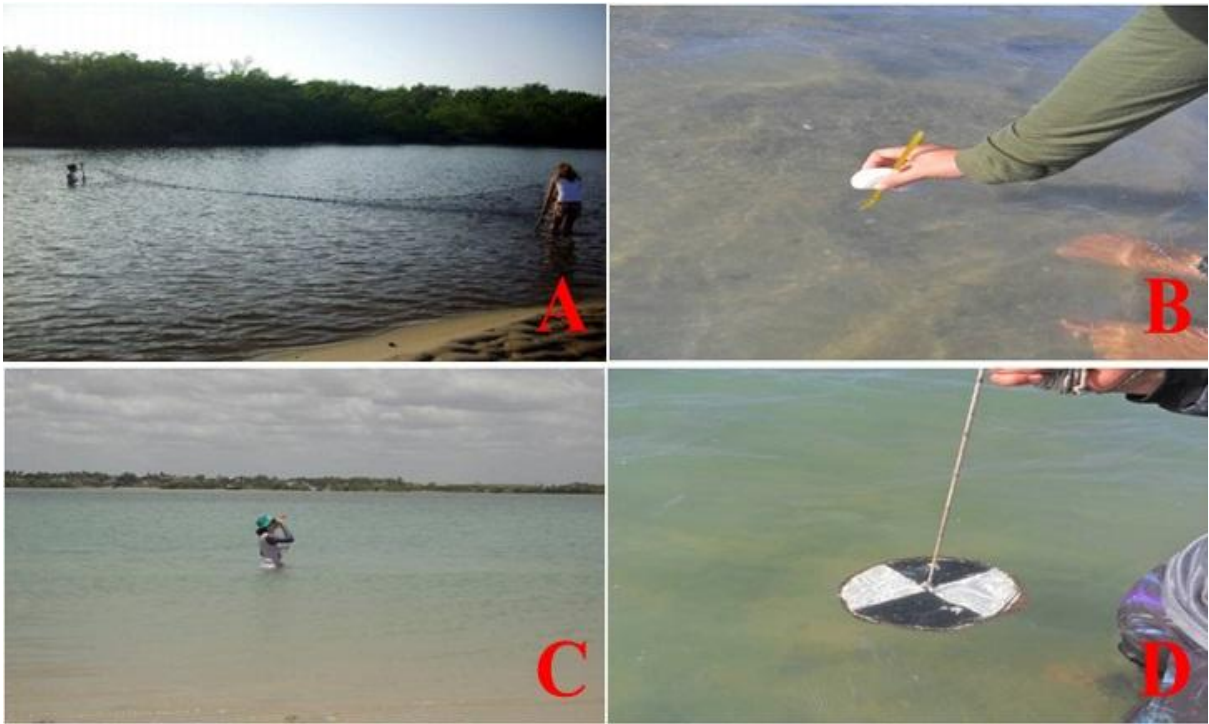
Figura 4 – Procedimento de coleta. A – Arrasto; B – Aferição de temperatura; C – Aferição de salinidade; D – medição de transparência e profundidade.
