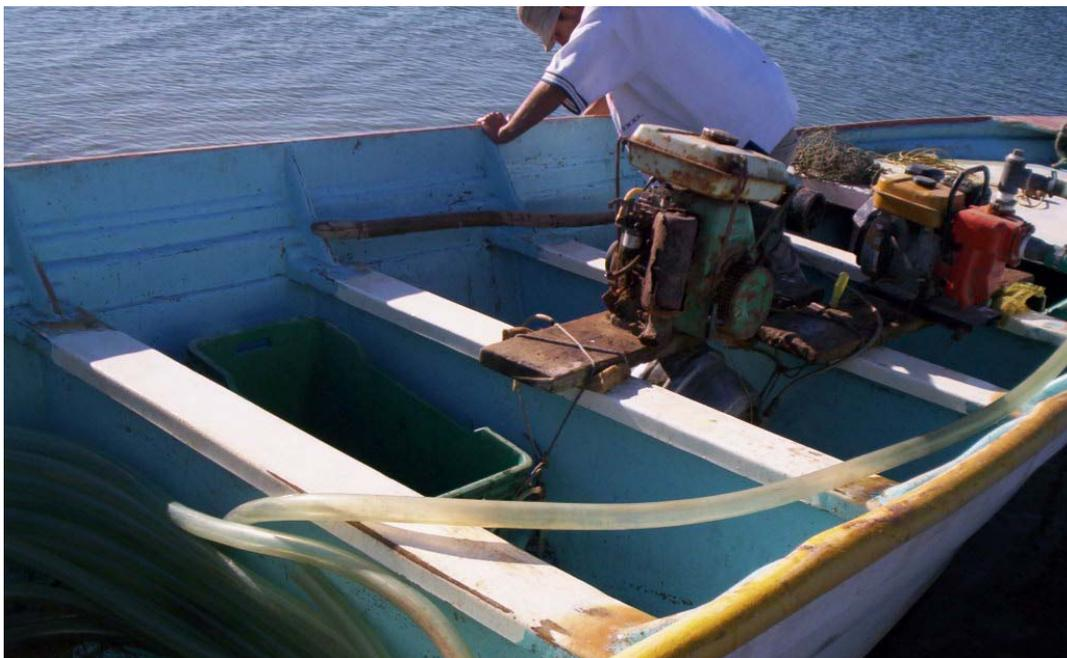
Figura 7. Compresor utilizado para la extracción de la Almeja de Sifón
