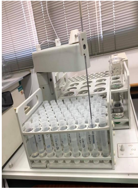
Figura 25. Analisis de cromo, níquel, cadmio y plomo por medio del equipo de espectrometría de absorción atómica por atomización de llama.
