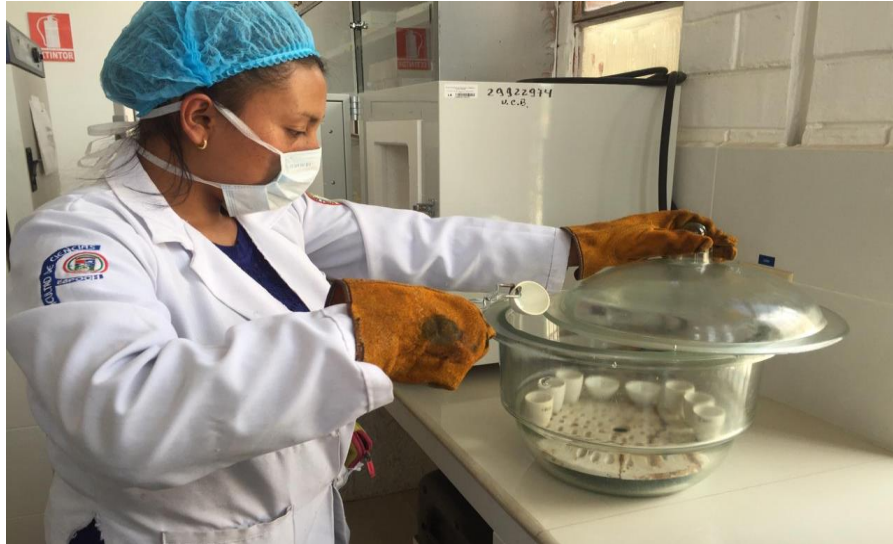
Figura 9-2. Determinación de materia orgánica
