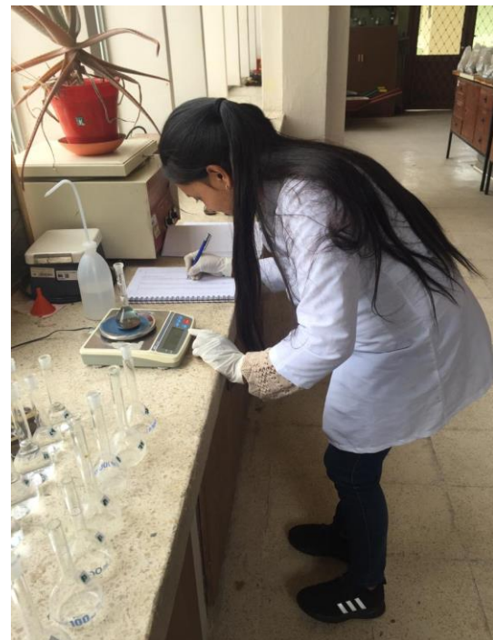
Figura 24. Determinación del peso del picnómetro para el análisis de la densidad de suelos
