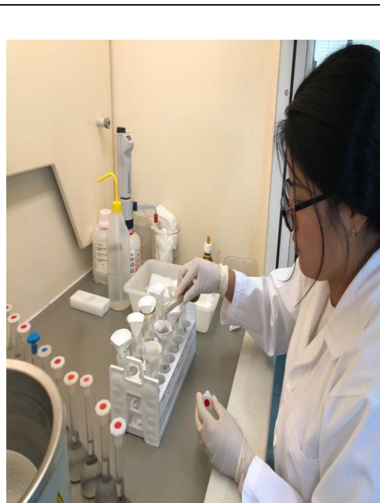
Figura 24. Muestras filtradas dentro de tubos falcón con la ayuda de papel filtro y embudos.
