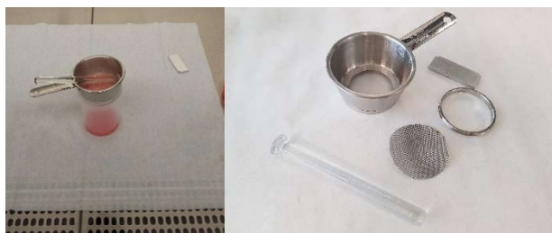
Figura 3.1: Herramientas para la obtención de cultivos primarios. Sieve tissue grinder de Sigma-Aldrich.
