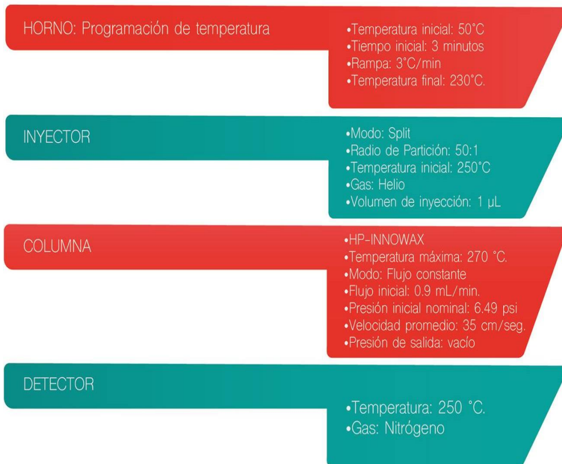
Figura 14. Condiciones operacionales para CG-EM en la columna HP-INNOWAX Fuente: La autora, 2016
