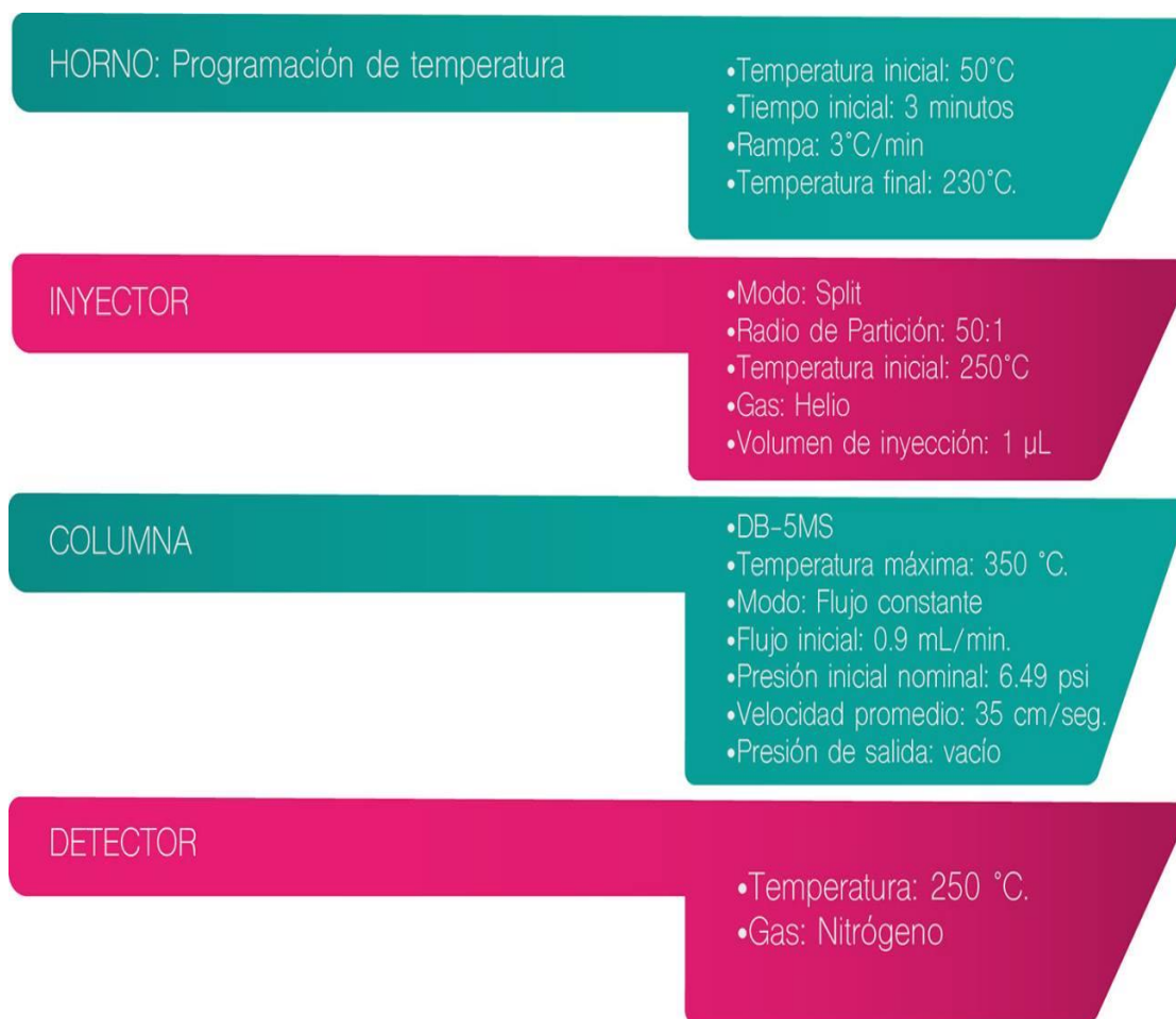
Figura 13. Condiciones operacionales para CG-EM en la columna DB-5MS. Fuente: La autora, 2016
