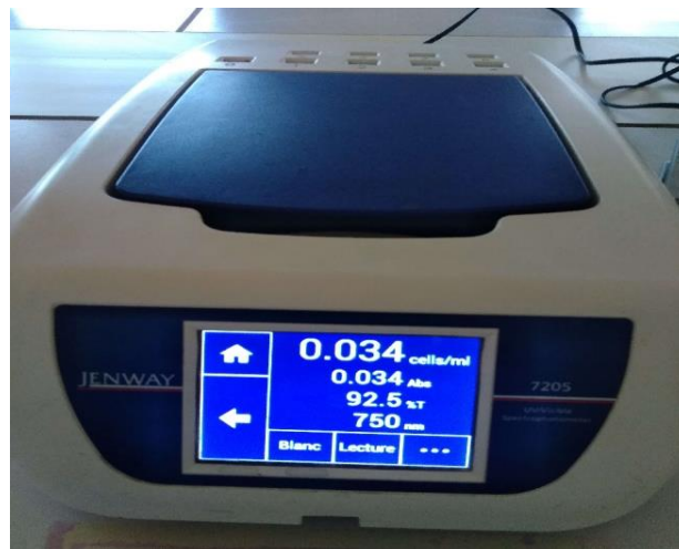
Figure 19 : La lecture de la densité optique avec un spectrophotomètre
