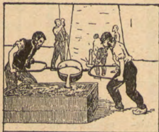
11. Se juntan nuevamente los dos bastidores , y se vierte el metal fundido , que cae en la huella marcada en la arena por el modelo de madera.
