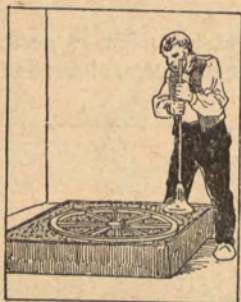
7. Obrero apisonando* arena en un bastidor alrededor de una rueda que sirve de modelo .
