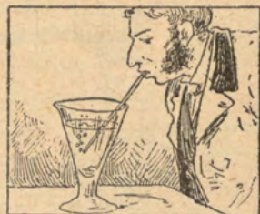
93. Para comprender lo que ocurre, soplese con un tubito en agua que contenga cal en disolución. Como el aire que sale de los pulmones está cargado de ácido carbónico, la cal al mezclarse con el ácido, se convierte en caliza (pág. 7, fig. 2) y se deposita en el fondo del vaso
