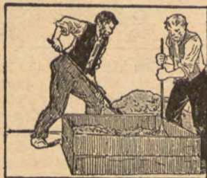
9. Obrero apisonando arena en el segundo bastidor , en el que se deja un hueco por donde se ha de verter el metal.
