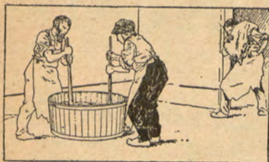
39. Se baten las pieles para ablandarlas, y se dejan en agua de cal para que se esponjen.
