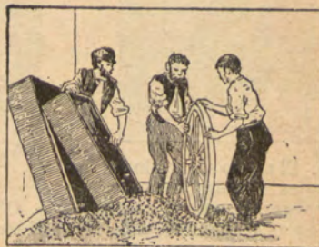
12. Cuando el metal se ha enfriado, se separan los bastidores y se retira un objeto fundido , que es semejante al modelo.
