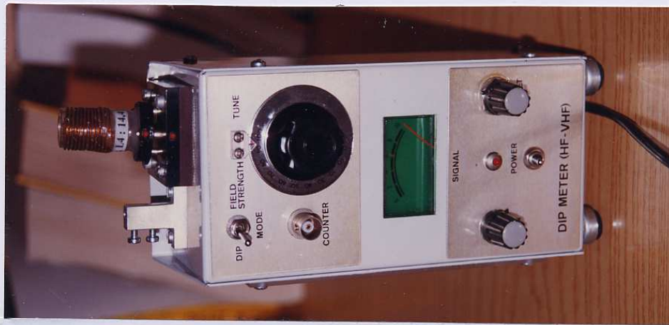
Figura N°6: Vista exterior del Dip Meter, de izquierda a derecha además de la bobina L enchufable, el soporte del sistema de captación. A continuación, el selector de Modo, el mando de sintonía, la salida de señal de RF Counter, el indicador del Dip o nivel de campo y los mandos de ganancia, centrado y Power. Se ha añadido un toma auxiliar de +12V que no aparece en la foto.
