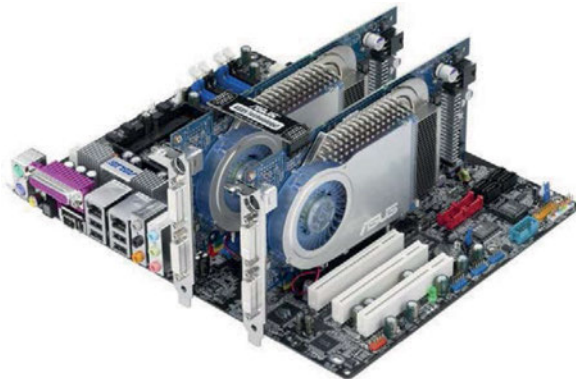
Εικόνα 1.3: Εγκατάσταση διπλών καρτών γραφικών τεχνολογίας SLI
