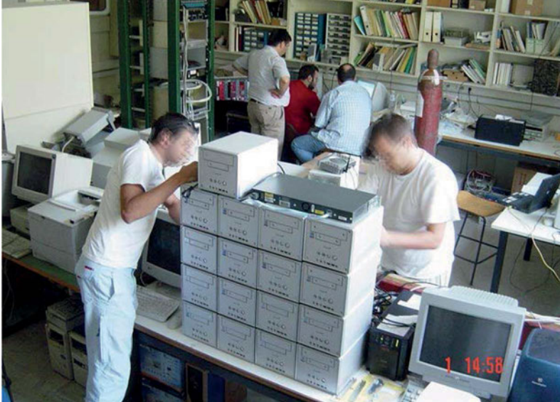
Εικόνα 4.1. Η συστοιχία 16 υδρόψυκτων υπολογιστών που κατασκευάστηκε στο Εργαστήριο Πειραματικής Φυσικής Υψηλών Ενεργειών της Σχολής Εφαρμοσμένων Μαθηματικών και Φυσικών Επιστημών του ΕΜΠ (Τροποποιημένη από: https://dimitris.apeiro.gr/images/cluster/2.jpg )
