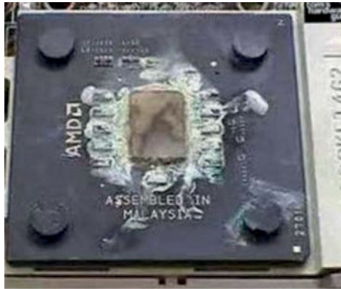
Εικόνα 2.1: Κατεστραμμένη Κ.Μ.Ε., λόγω υπερθέρμανσης
