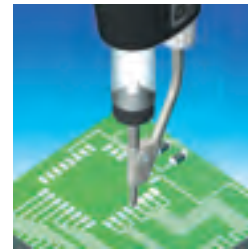
Reinigung der Leiterpads mit dem Entlötkolben
