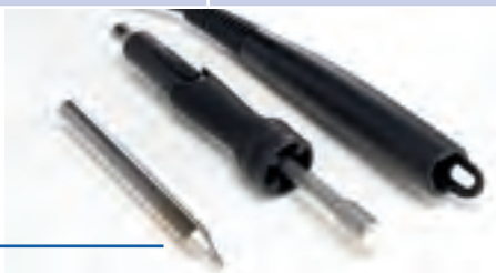
Lötspitzen-Lötgriffel mit Heizspule
