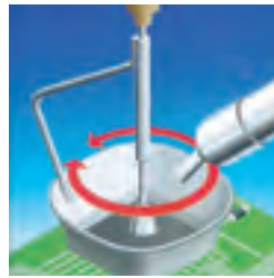
Entlöten mit Heißluft
