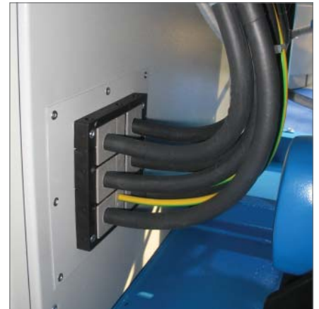
KEL 24|12-2MT - Seite 22 Einführung von 6 großen Leitungen (bis 34 mm) mit nur einer Kabeleinführungsleiste, dadurch ist nur ein Ausbruch notwendig.
