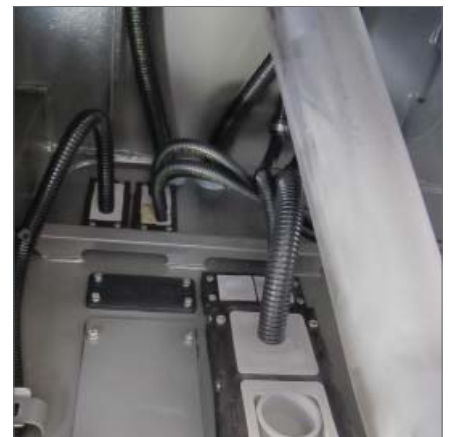
KEL-JUMBO 2 - Seite 48 / KEL 24|x - Seite 16 Einführung von Wellschläuchen und Leitungen im Fahrzeugrahmen.
