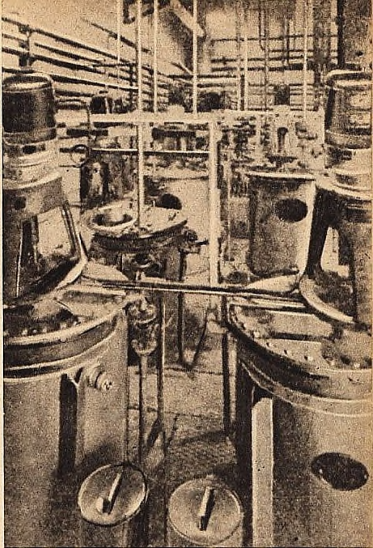
Rozsdamentes acélból készült vákumbepárlókban sűrítik a penicillinoldatot.
