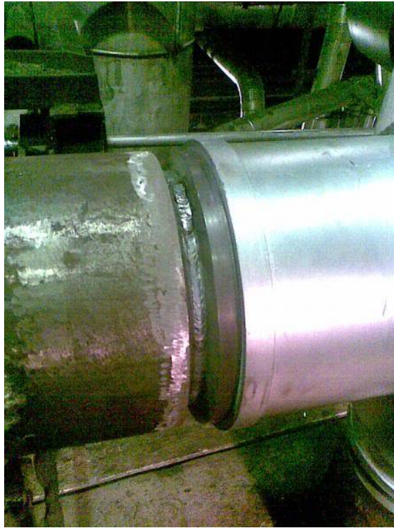
157. ábra Többsoros hegesztési varrat töltése
