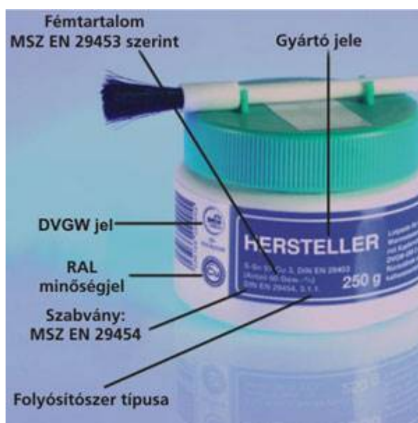
250. ábra Lágyforrasztó paszta jelölései
