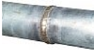
217. ábra Tűzi horganyzott cső keményforrasztott kötással
