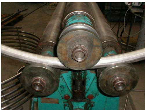
195. ábra Görgős csőív hengerítő és hengerített hőcserélő csőkígyó
