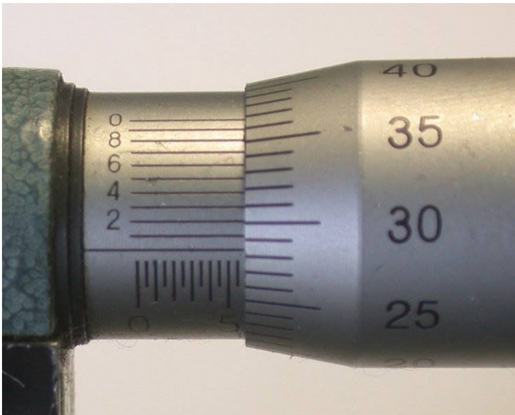
12. ábra A mikrométeren leolvasott méret: 5,783 mm
