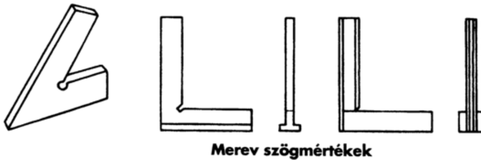
19. ábra Az előírt szög ellenőrzése idomszerrel
