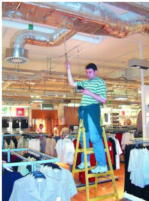
345. ábra. Térfogatáram mérése téglalap alakú légszatórnában
