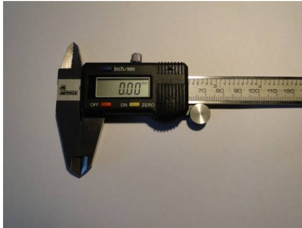
5. ábra Mechanikus és elektronikus kijelzésű tolómérő
