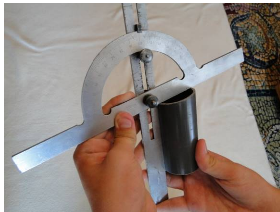
16. ábra Cső ferde vágásának szögmérése
