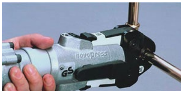
263. ábra Préskötés készítése
