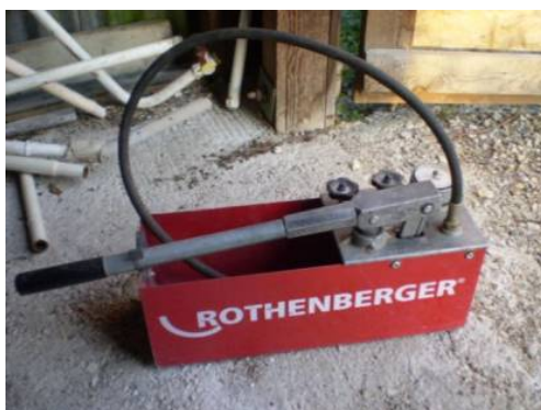
347. ábra Nyomáspróba pumpa
