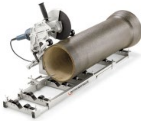
180. ábra Sarokcsiszoló befogására alkalmas csővágó
