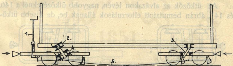
145. ábra. (2) Asztal-hordgerendák, (3) derékszög, (4) alváz-hordgerendák elgörbüléseinek keresztmetszete, az elgörbülések folytán hosszúra vált második fék féktuskóinak és (5) vonórudjának állása az (1) féksavar teljes meghuzása mellett.
