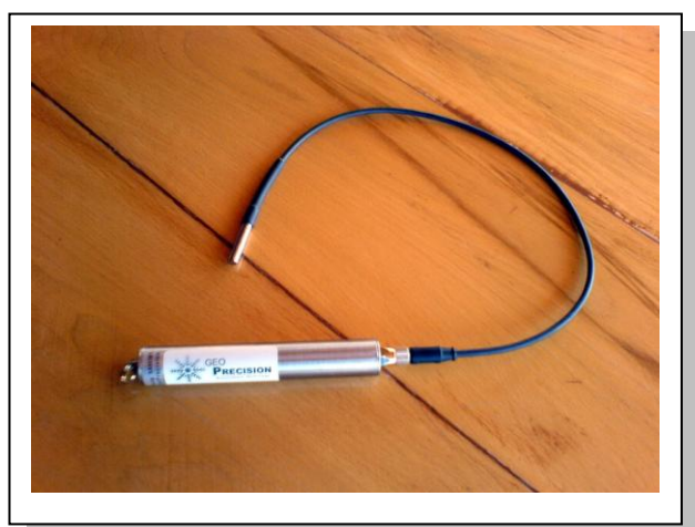
სურ.13 ტემპერატურული მინილოგერი „GEO-Precision“
