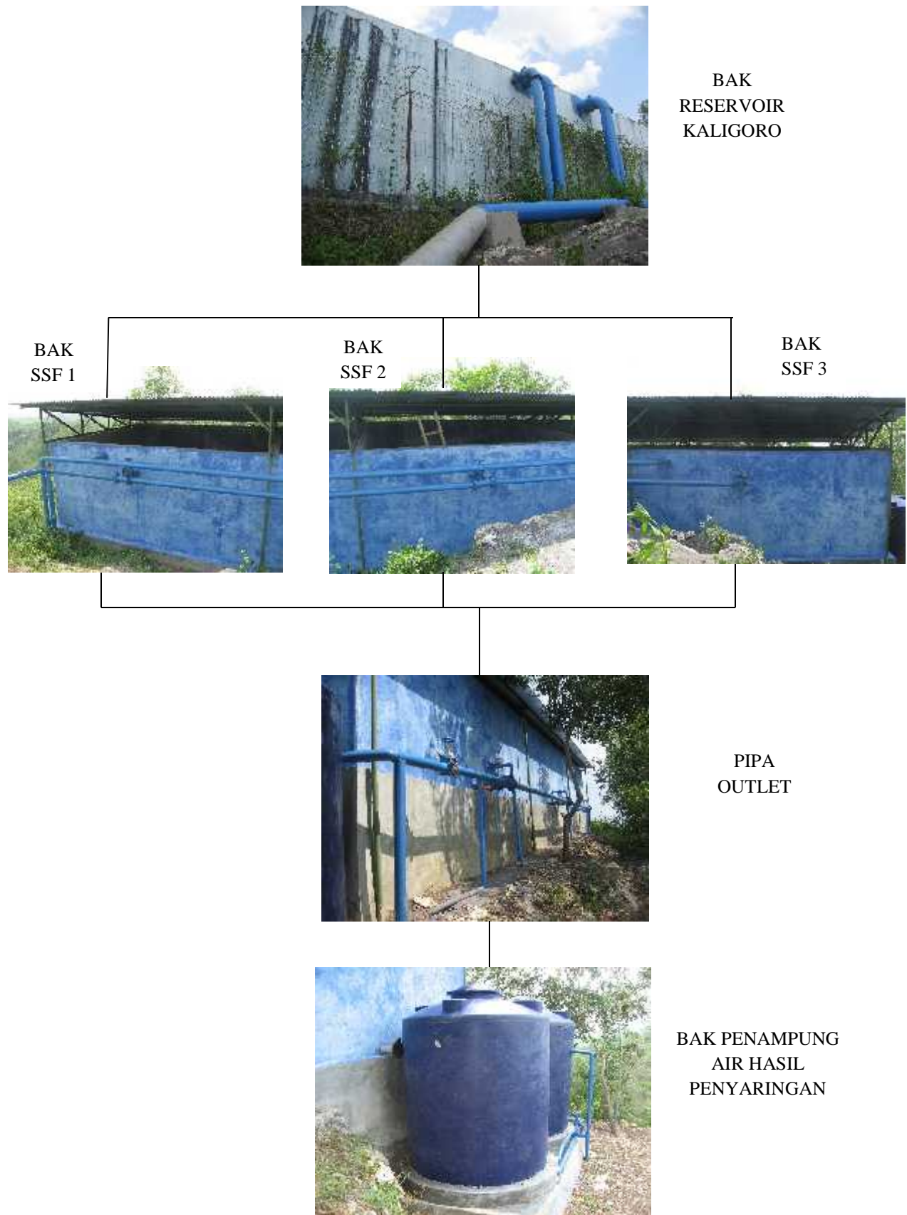
Gambar 5.4 Skema Sistem Saringan Pasir Lambat Kaligoro
