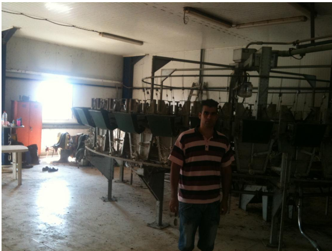
Εικ. 12. Αμελκτήριο τύπου Caroussel στη μονάδα του κ. Φουνταλή.
