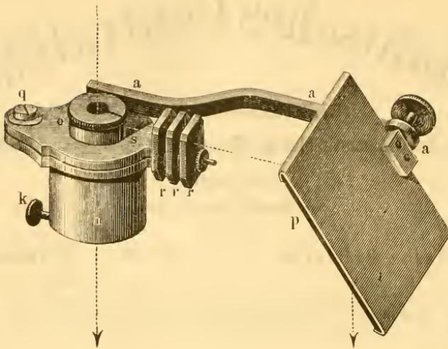
4. Der obere Theil des Apparates ist um den Punkt *q* an der durch die Schraube *k* am Mikroskoprohr befestigten Hülse *h* beweglich und kann durch eine leichte Drehung ausser und wieder in Wirksamkeit gesetzt werden, und endlich
