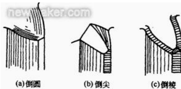
图 9-18 齿端加工形式
