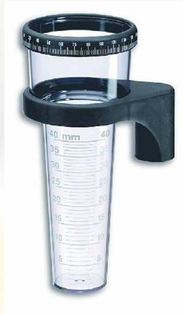
Lo strumento per misurare la piovosità si chiama **Pluviometro**
