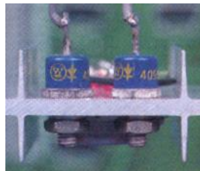
Fig. 7 disipación de calor. Las flechas amarillas indican la dirección de la corriente en pasofácil. Fig. 8 Diodos instalados en un dispositivo de alta
