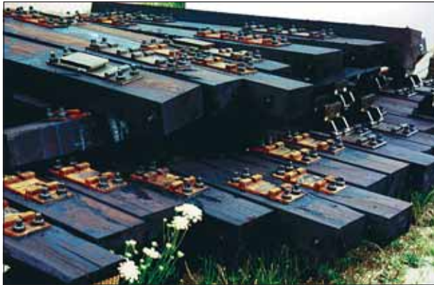
Abb. 4: Frisch imprägnierte Bahnschwellen auf einem Lagerplatz am Verschiebebahnhof Wels, die stark stechend nach Steinkohlenteeröl riechen.
