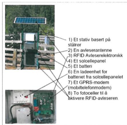
Figur 35: Oversikt over avleserstasjon ved et saltslikkesteinområde.
