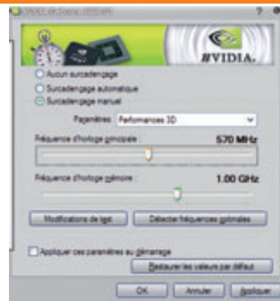
Comme c'est le cas pour vous et pour tout le monde, la fréquence mémoire indiquée ici est une fréquence « DDR ». La cadence réelle imposée aux puces est ici de 500 MHz.
