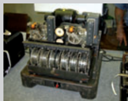
La machine de Lorenz permettait de crypter les informations ultraconfidentielles des Allemands pendant la Seconde Guerre mondiale.
