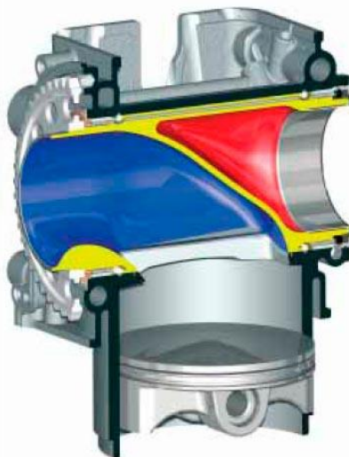
12. ábra: BRV forgószelepes konstrukciója [20]
