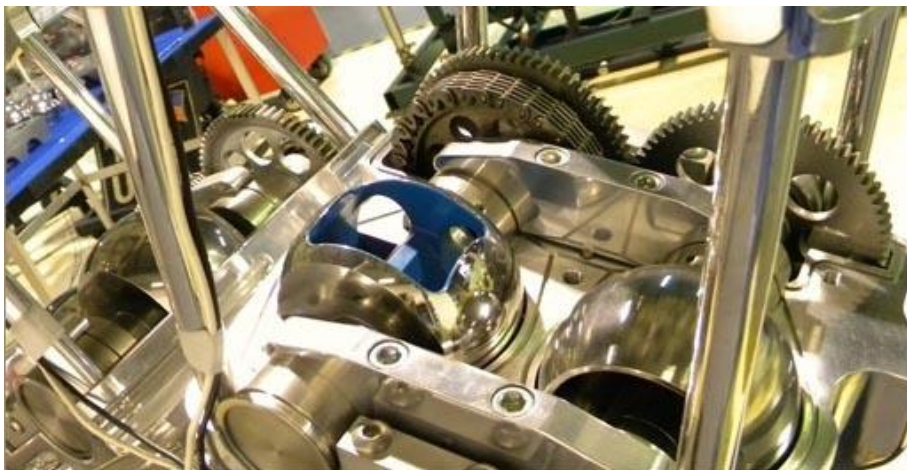
19. ábra: Coates forgószelepes motorja [24]
