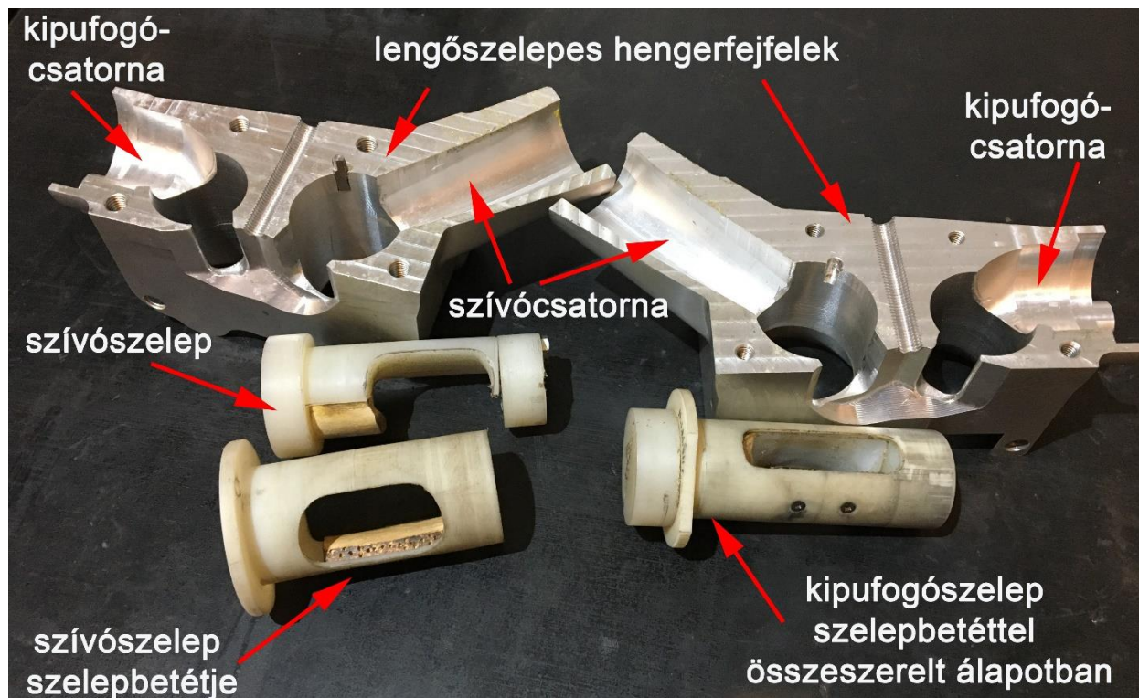
57. ábra: Áramlástani vizsgálatok céljából készített lengőszelepes hengerfej és részei szétszerelt állapotban
