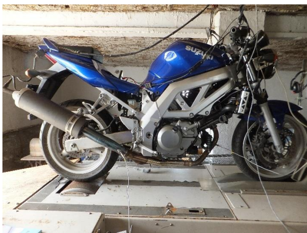
37. ábra: Suzuki SV650 motorikus jellemzőinek meghatározása a görgős teljesítménymérő padon
