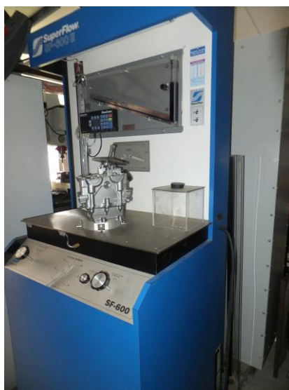
34. ábra: SuperFlow SF6-600 áramlásmérő berendezés az ülékes szeleppel szerelt hengerfej mérése közben
