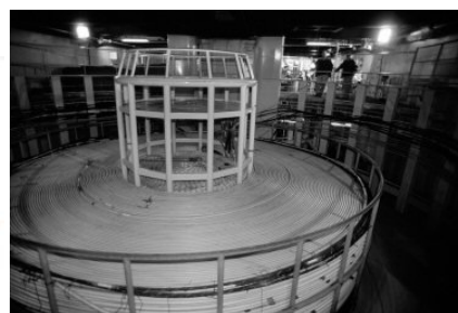
a, b, 1.7. ábra. Kábelfektető hajó metszeti képe (a.) és a hajó gyomrában lévő kábeltárolók egyike. (b.)
