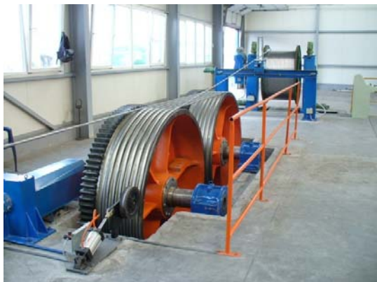
1.3. ábra. Egy szabadvezeték-sodró gépnél használt súrlódó hajtás, [22]
