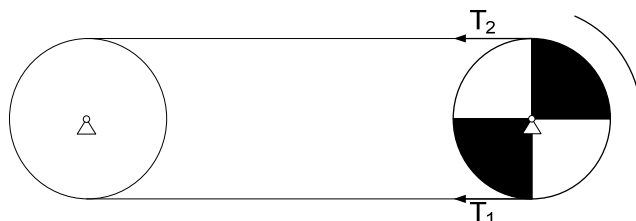
2.24. ábra. Egyszerű végtelenített vonóelemmel rendelkező dobhajtásos rendszer. A két dobból csak a jobboldali hajtott
