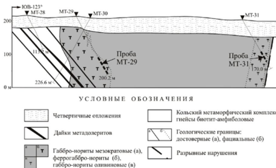
Рис. 2. Геологический разрез по скважинам МТ-28 – МТ-31 массива Кириха.
