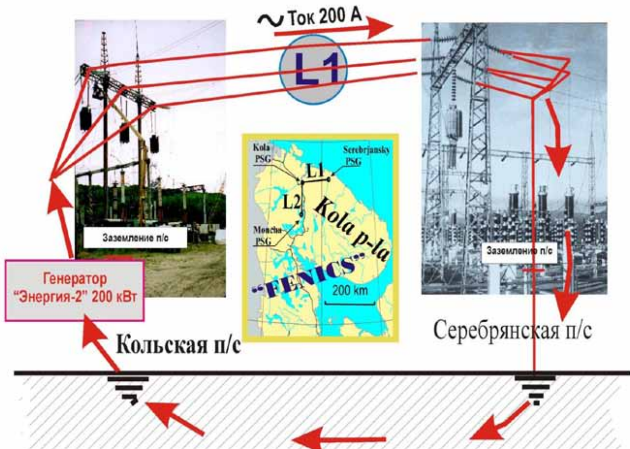
Рис. 3. Схема подключения генератора «Энергия-2» к промышленной ЛЭП «Кола-Серебрянка».
