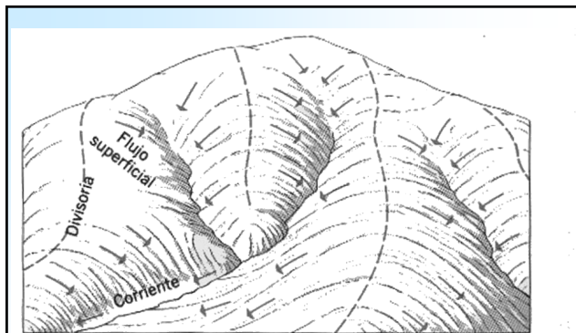
FIGURA 11.12. Flujo superficial que desciende por las laderas de la cabecera de un sistema hidrográfico, aporta agua y sedimentos a la incipiente red de canales.
