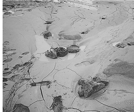
噴砂に伴い噴出した海成粘土（中浜干拓地）。水田の客土として用いられた米子湾の底質が噴出した例。
