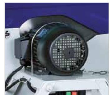
Leistungsstarke **Spezial-Kreissägen-Motoren mit elektronischer Bremse** und eingebautem Wicklungsfühler, der die Temperatur direkt im Motor und nicht am Schalter misst (P2 Abgabeleistung).
