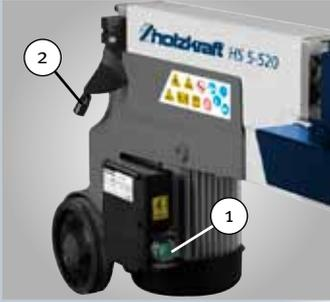
Eine hohe Betriebssicherheit wird durch die Zwei-Hand-Sicherheits-schaltung gewährleistet. Durch Druck auf den Betriebsknopf (1) und gleichzeitiger Betätigung des Bedienelements (2) wird der Spaltvorgang gestartet.
