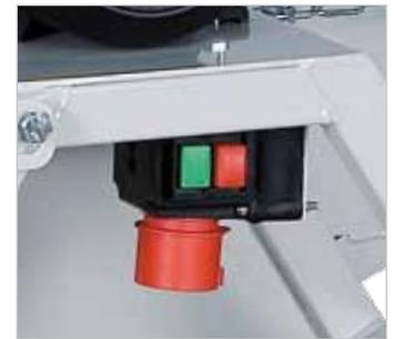
**Schalter-Stecker-Kombination:** Serienmäßig mit Phasenwender und Nullspannungsauslöser (400V/16A).
