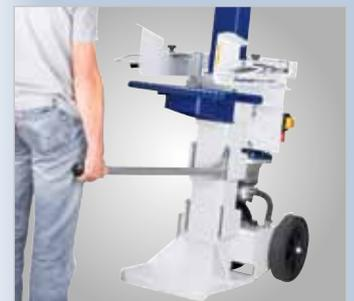
Der Transporthebel wird einfach in die Tischhalterung eingesteckt und sorgt für einen einfachen Transport.
