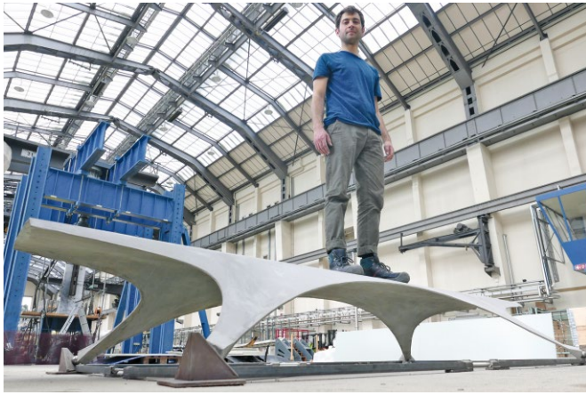
Bild 5 Prototyp einer Schalenbrücke aus Textilbeton Prototype of a textile reinforced concrete shell bridge
