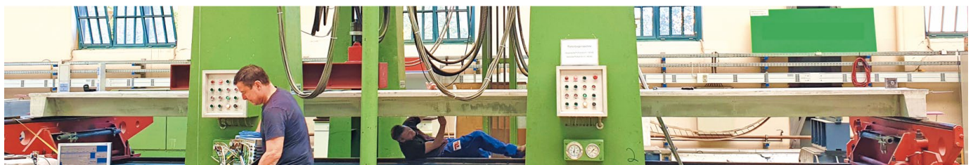
Bild 17 Vorbereitung des Vier-Punkt-Biegeversuchs der 8,71 m Trapezplatte Preparation of the four-bending test of a folded slab with a length of 8,71 m
