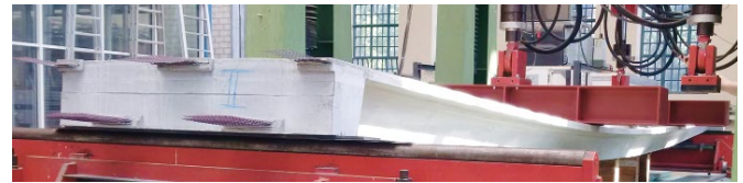
Bild 15 Vier-Punkt-Biegeversuch der Trapezplatte Four-bending test of a folded slab
