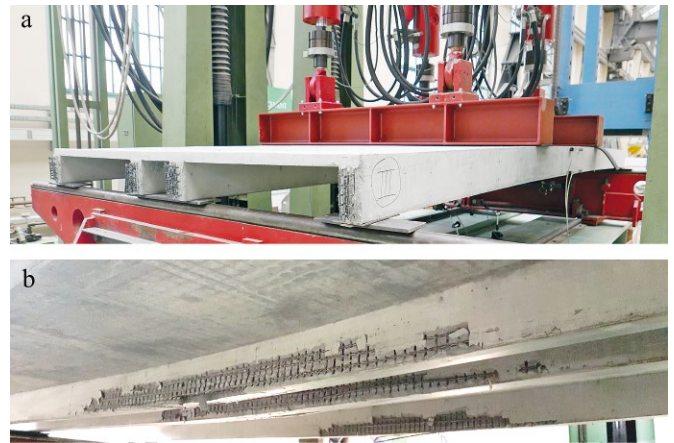
Bild 11 a. Vier-Punkt-Biegeversuch, b. Biegeversagen a. Four-point-bending test, b. Bending failure
