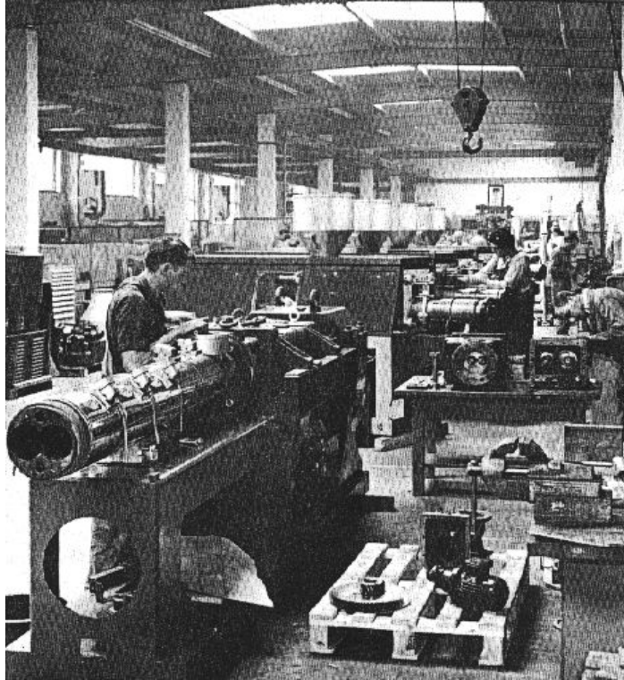
8.23 ábra: Kétcsigás extruder szerelés közben [8.9]
