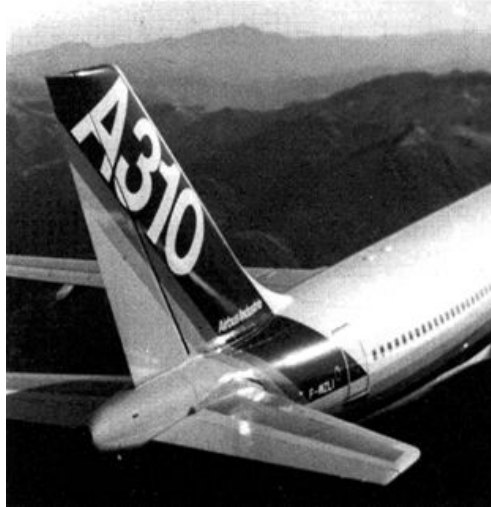
14.25 ábra: Az AIRBUS–310 repülőgép polimer kompozitból készült függőleges vezérsíkjá [14.13]
